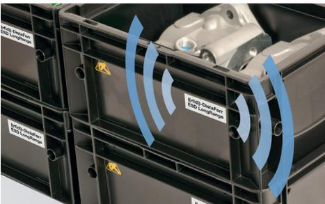
Das ((rfid))-DistaFerr ESD Long-Range Label ist für ESD-Behälter aller Varianten und Antistatik-Level konzipiert und verfügt über eine Lesereichweite von bis zu 7 Metern. Damit erfüllt es die Empfehlung des Verbandes der Automobilindustrie (VDA). Es ist wasch- und witterungsbeständig, kann automatisiert verarbeitet und per TTR-Druck auf RFID-Druckern beschriftet werden.
