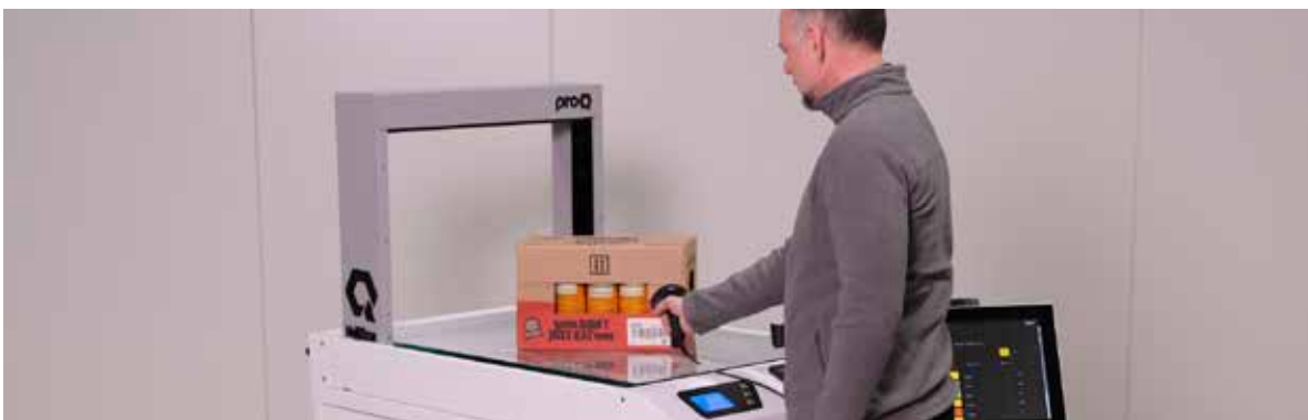
MultiScan von proQ: Automatisierte Erfassung von Verpackungs- und Artikeldaten in einem Prozessschritt.
