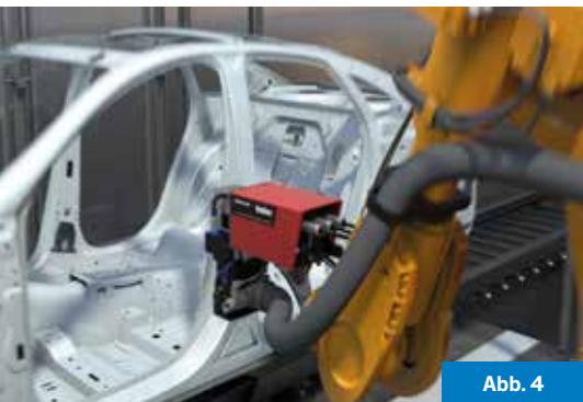
Abb. 4: Eine nahtlose Einbindung in die Produktionslinie erlaubt ohne zusätzliche Rüst- und Umstellkosten Markierungen ab Losgröße 1. (Urheber: Trotec)
