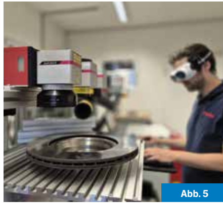
Abb.5: InMarker: Als einer der kleinsten Integrationslaser auf dem Markt ist, der InMarker dank robustem Gehäuse und Schutzklasse IP54 auch für raue Umgebungen geeignet. (Urheber: Trotec)
