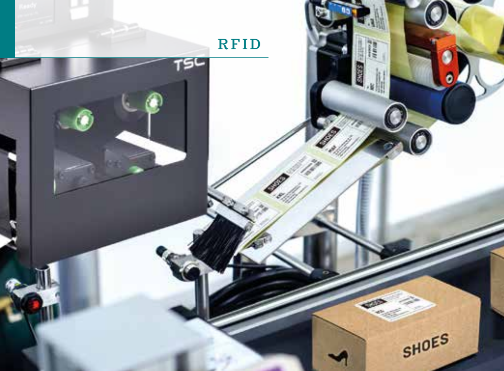
Mit dem Industriedrucker T6000e von TSC Auto ID können Anwender Standard-RFID-Etiketten sowie On-Metal-RFID-Tags drucken und codieren. (© TSC Auto ID)
