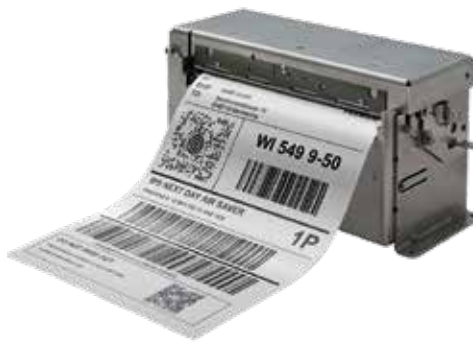
Der Cutter im GeBE-VARIO Plus Linerless Thermodrucker erreicht mit empfohlenem Papier aktuell zwei Millionen und mehr Schnitte, ohne Reinigung der Schneidemes- ser.
