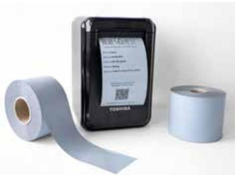
So wie herkömmliches Blue4est POS-Papier ist Blue4est Pro garantiert frei von chemischen Entwicklern und kann auf herkömmlichen Thermodruckern eingesetzt werden. Anstelle einer chemischen Reaktion auf Wärme nutzt Blue4est Thermopapier einen rein physikalischen Mechanismus für seine Druckergebnisse. Winzige Bläschen in der Funktionsschicht zerfallen unter der Hitzeeinwirkung des Thermodruckkopfs, wodurch die dar-
