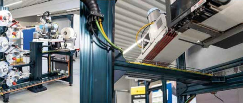
arm ist ein speziell optimierter Riemenapplikator verbaut. Dieser übernimmt das Etikett direkt von der Spendekante des jeweiligen Etikettiersystems. Der Cobot bewegt sich nun - mit dem Etikett am
