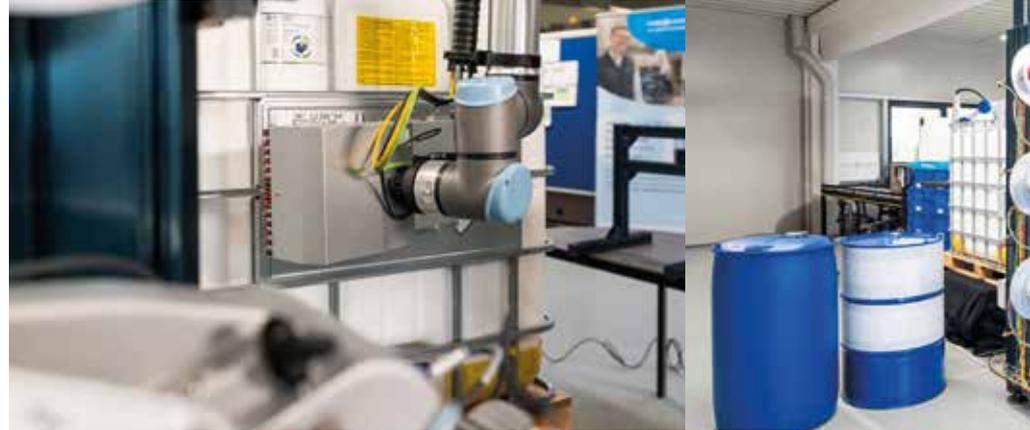
*„Der Kunde hatte die Anforderung, Behältnisse mit chemischen Flüssigkeiten auf engstem Raum mit unterschiedlichen Etikettenformaten zu kennzeichnen. Gemeinsam mit Bluhm haben wir eine sehr flexible und anpassungsfähige Roboterzelle entwickelt, die mit hoher Performance und Qualität Gefahrstoff- und Produktetiketten bedruckt und appliziert.“*
