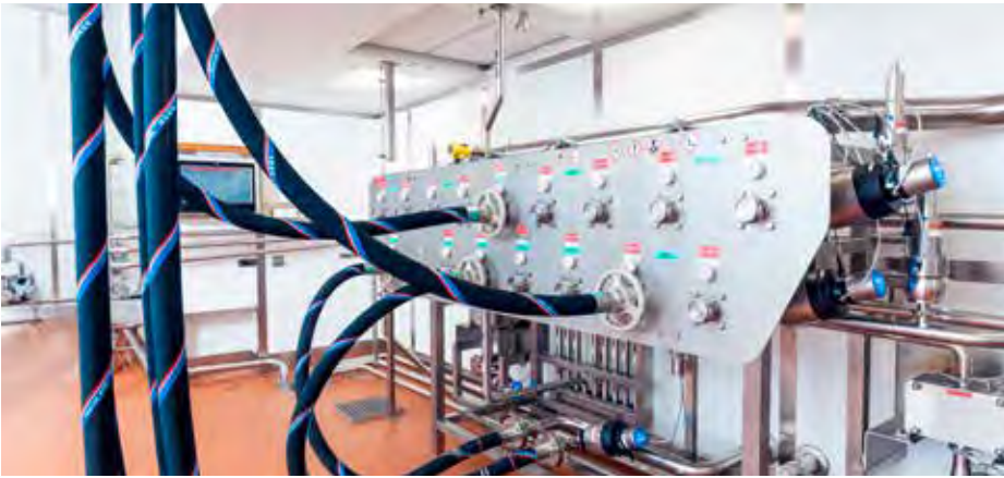
Turcks BL ident-RFID-System verhindert Fehlkupplungen und gewährleistet damit eine konstante Produktqualität
