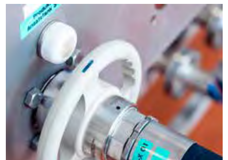
Sobald der Schlauch verbunden ist, verifiziert das RFID-System den Anschluss
