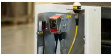
Leuze Sensortechnik an einer Docking-Station im Detail. Unter der geöffneten Abdeckung ist links ein HT5.1/4X zur Anwesenheitserkennung der Palette installiert. Der kamerabasierte Codeleser DCR 202iC (Mitte) erfasst Auftrags- und Materialdaten über den 2D-Code der Palette. Das Signallicht rechts informiert über den aktuellen Status per Farbsignal.
