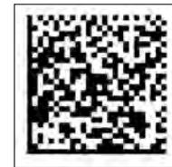
Abb. 7: AutoID URL 1.0 codiert im DataMatrix führt zu der WEB-Seite des Motors mit der Seriennummer „400D02“ (<https://www.e-d-c.info/autoid/?25p=qcelmiaq7b4&s=400d02>).
