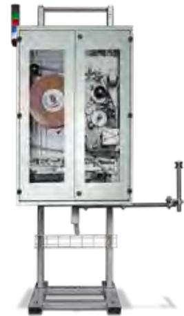
lette zwei Etiketten und bringt sie an der Sicherungsschnur an. Dabei wird jedes Etikett so über die Schnur geklappt, dass die Klebseiten gegeneinander haften. Im End-of-Line-Bereich der Palettieranlage von Rothaus werden so pro Stunde bis zu 85 Paletten zweiseitig gekennzeichnet.
