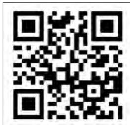
Abb. 1: Diese Bild zeigt einen ISO/IEC 15459-4 konformen Code eines individuell serialisierten Produktes, der jederzeit und überall eindeutige Identifikation ermöglicht, hier einmal in QR-Code als Datenträger.
