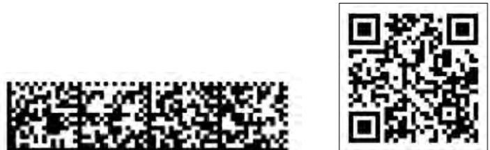
Abb. 8: AutoID URL 1.0 codiert im DataMatrix – DMRE oder auch im QR-Code führt zu der WEB-Seite des Instrumentes mit der Seriennummer „400303“ (<https://www.e-d-c.info/autoid/?25p=rhhibc800b400&s=400d02>).
