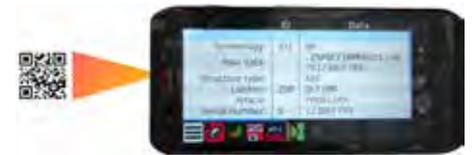
Abb. 2: Smartphone-Scan und die per App offline interpretierten Daten des QR der Abb. 1: Firmen-ID, Modell, Seriennummer (Bildquelle Elmicron).
