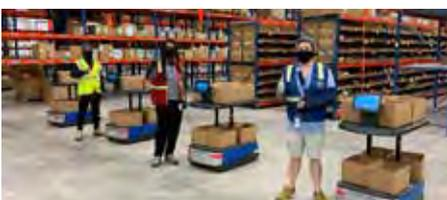
Abhängig von den täglichen Volumina und Auftragsprofilen kann Chuck nicht nur gleichzeitig Einzelaufträge kommissionieren, sondern auch Batch-Picking, Zonen- und Cluster-Kommissionierung unterstützen.
