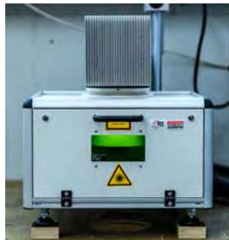
von Millisekunden keilförmige Vertiefungen, die die Farbe und Struktur des Materials derart verändern, dass kontrastreiche Codierungen entstehen. Diese Gravuren dienen der fälschungssicheren und verschleißbeständigen Produktkennzeichnung. Auch bei anschließenden Beschichtungsprozessen bleibt die Markierung zumeist gut sichtbar.
