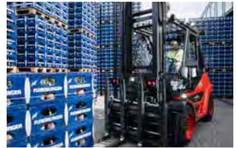
Jeweils 2 Lesegeräte des Modells DataMan 360 sind am Hubgerüst der Linde-Stapler montiert und lesen zuverlässig die 1D-Barcodes auf den zu verladenden Paletten.
