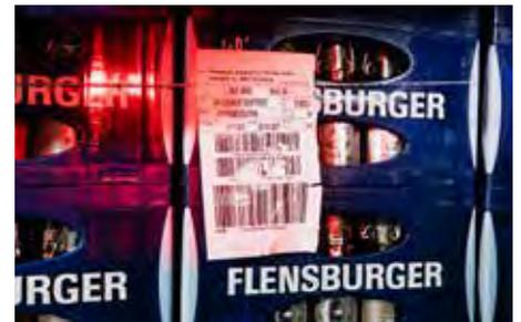
Selbst zerknitterte, eingerissene oder reflektierende Codes können mit den robusten Algorithmen der auf Bildverarbeitung basierenden Geräte gelesen werden.
