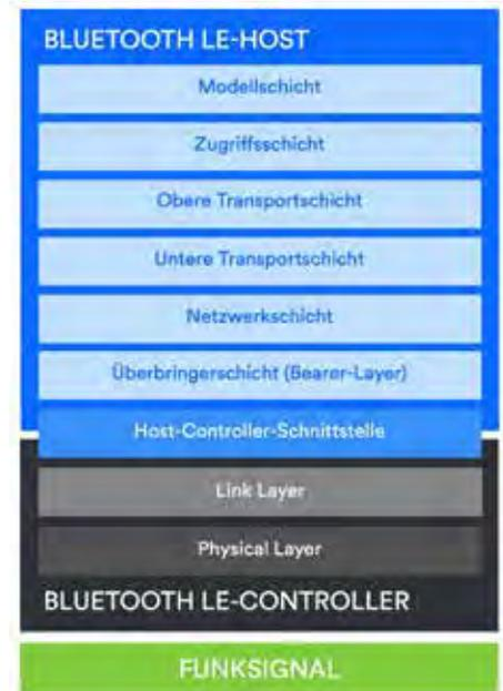
Stack-Konfiguration, die Bluetooth Mesh unterstützt
