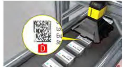
Codes und liefert detaillierte, zusammenfassende Berichte zum Nachweis der Konformität. Barcode-Verifizierer erfordern eine Kalibrierung, verwenden eine bestimmte Beleuchtung und prüfen alle Qualitätsparameter. Die Überwachung der Prüfergebnisse ermöglicht bei einer Verschlechterung der Qualität die Probleme des Codes zu ermitteln und unverzüglich Korrekturmaßnahmen zu ergreifen.
