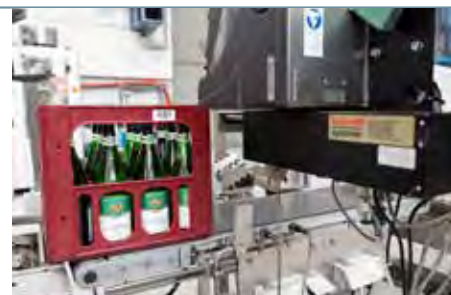
Der Etikettendruckspender Legi-Air 4050 bringt stündlich etwa 1.200 Barcodeetiketten auf Weinkästen auf.
