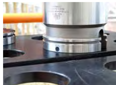
Die BIS M-Datenträger von BALLUFF in den Werkzeugaufnahmen entsprechen den offenen, normierten RFID-Standards ISO 15693 und ISO 14443A
