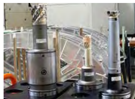
Bei Premium AEROTEC sind rund 30.000 Werkzeuge in den Werkzeugaufnahmen mit BIS M-Datenträgern von BALLUFF ausgestattet
