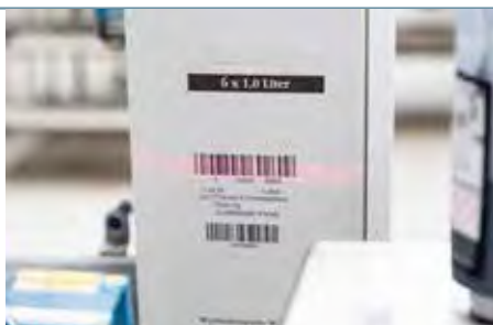
Unmittelbar nach dem Aufdruck wird die Lesbarkeit des Barcodes gecheckt.
