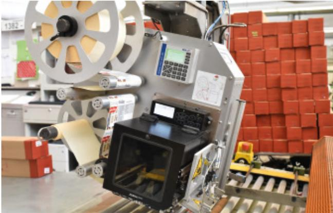
Druckspendesystem für die Rundumetikettierung
