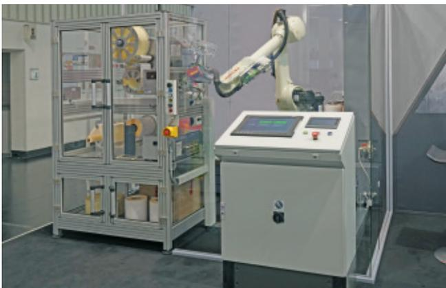
Roboterzelle mit 1:1 Vollfarbdruck und Spendemodul
