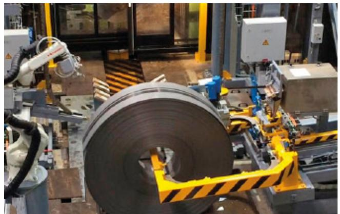
Etikettierung von Stahlcoils
