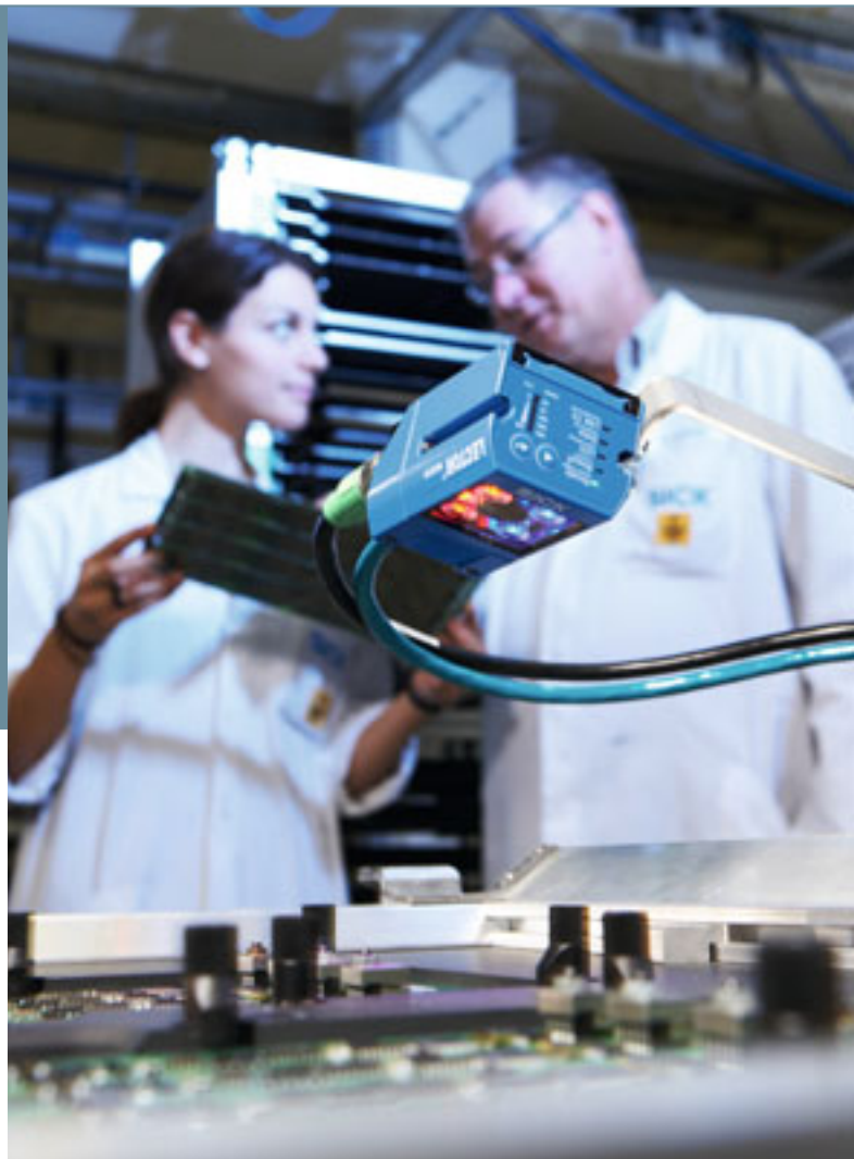
Der LECTOR® 620 „DPM“ ist die optimale Lösung für direkt aufgebrachte Kennzeichnungen, wie sie u.a. in der Elektronik- und Solarindustrie dominieren
