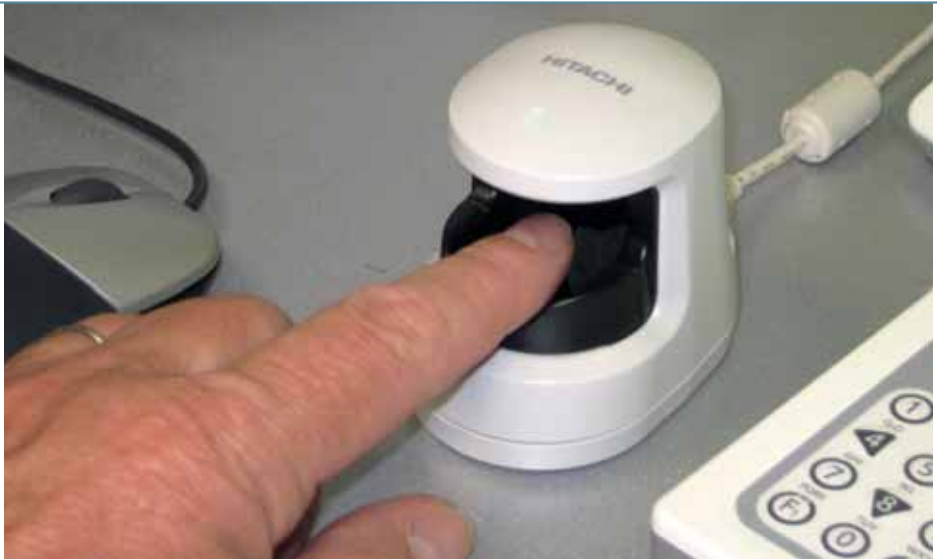
Ein neues Identifikationssystem zum Scannen von Fingern im eldentity-Labor bei Fraunhofer FOKUS: Hier wird nicht nur die Hautoberfläche gescannt, sondern auch das darunter liegende Venensystem
