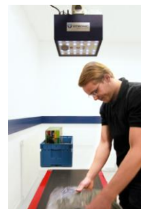
Beispiel für halbautomatische Datenerfassung: Codes werden erfasst, während die Ware unterhalb des Kamerasystems durchgeführt wird
