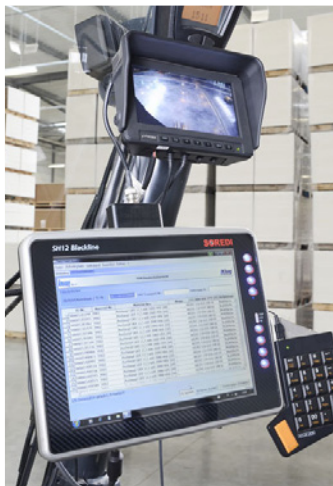
Panzerglas schützt eine extrem helle, kontrastreiche Bildschirmanzeige mit darunter liegendem, kapazitivem Touch Panel
