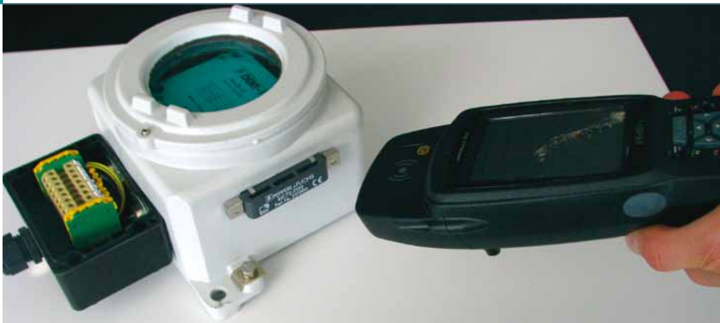
Lesen eines elektronischen Typenschildes mit einem Handlesegerät. (© Pepperl + Fuchs GmbH)
