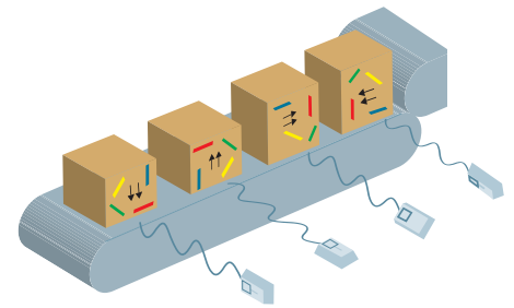
Erfassung der Ausrichtung von Objekten durch linear polarisierte RFID-Antennen
