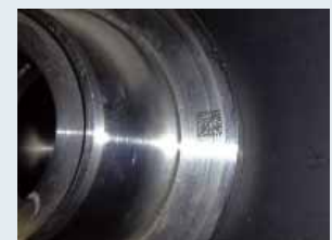
Data Matrix ECC 200 in quadratischer und gelasener Form mit Farbumschlag, (Werkbild Datalogic Automation)
