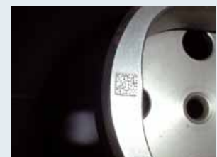
Data Matrix ECC 200 in quadratischer Form und im Nadelpprägungsverfahren erstellt, (Werkbild Datalogic Automation)
