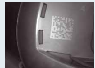
Data Matrix ECC 200 in quadratischer und gelasener Form mit Materialabtragung, (Werkbild Datalogic Automation)
