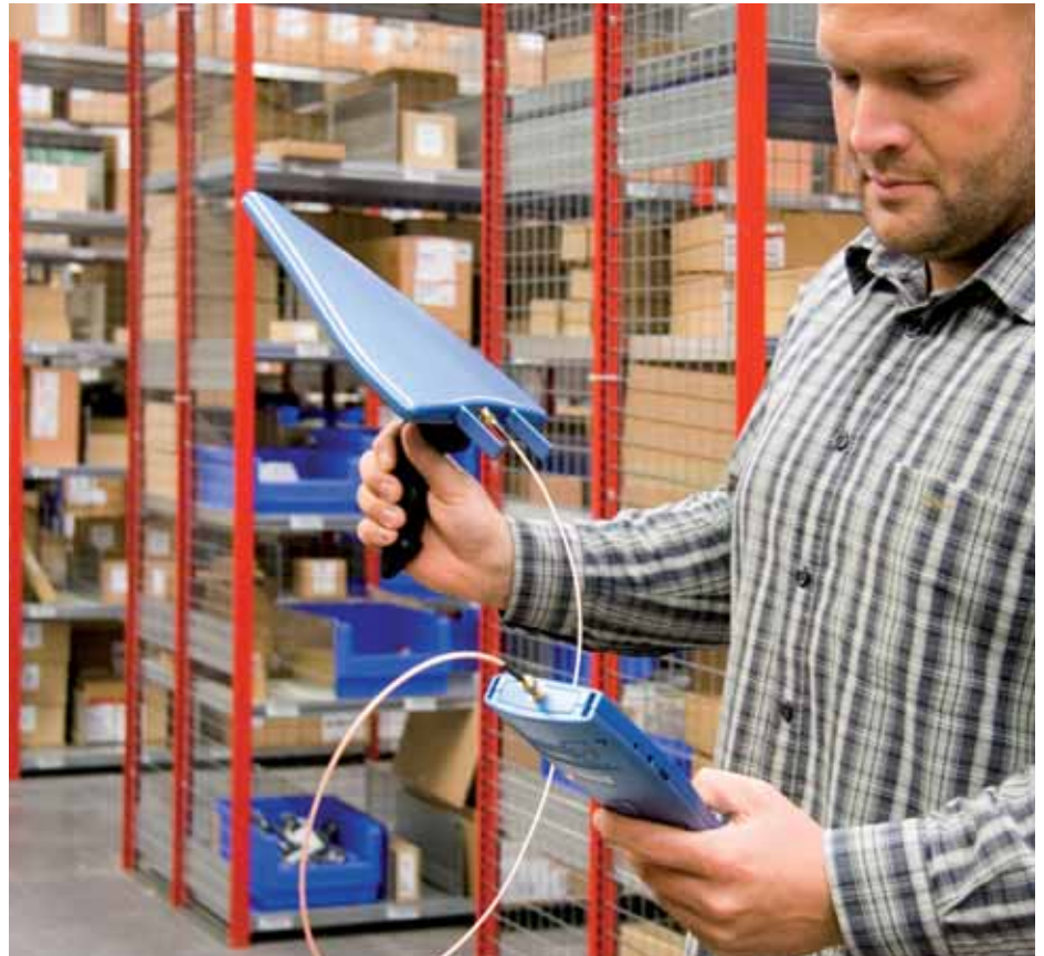
Ein professionelles Site-Survey stellt die Entscheidungsgrundlage für die zukünftige WLAN-Installation dar und gewährleistet eine flächendeckende Funkversorgung.
