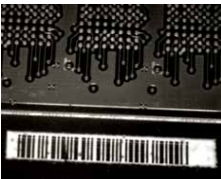
Strichcode mit einem Ink Jet Drucker auf weißem Hintergrund gedruckt, (Werkbild Datalogic)
